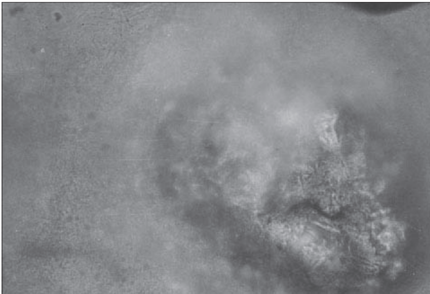
Figura 8.7 Partícula suporte (tamanho: 0,2 mm) envolvida por biofilme em ambiente anaeróbio.
